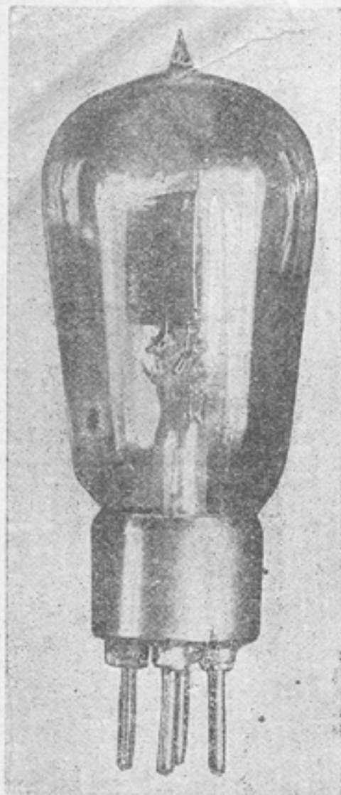
FIG. 7 - Valvola termoionica a tre elettrodi tipo "Gorizia".
