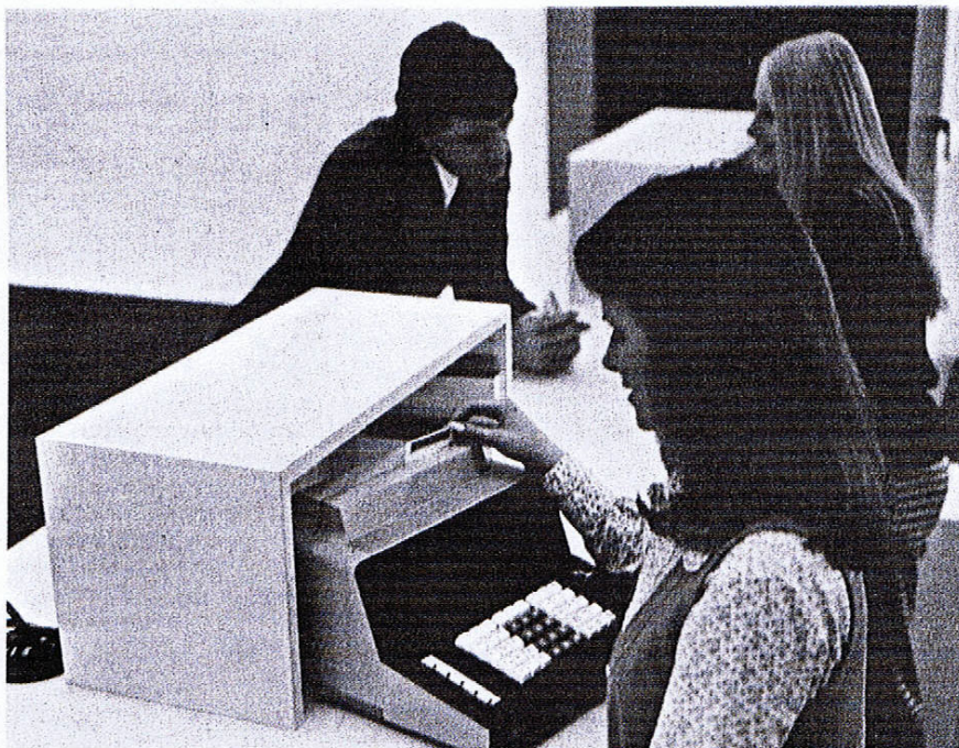
Terminale IBM 3600. Sistema terminale bancario specificatamente studiato per rispondere alle esigenze degli Istituti di credito. Dispone di unità video, di stampatrici e di un terminale per l'esecuzione automatica di alcune operazioni di sportello. Adottato dalla Banca Nazionale dell'Agricoltura, Banca Toscana, Banco di S. Spirito, consente lo svolgimento di tutte le operazioni di banca con il massimo della sicurezza. E' previsto infatti un codice che permette di identificare l'utente e di verificare l'autorizzazione ad accedere alle informazioni. A pag. 1 dell'inserto: modem per T.D. fornito in uso e manutenzione all'utente dalla SIP.
